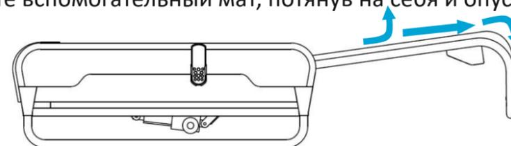
2. Между основным и доп. матом есть магнитный переключатель, перед тем, как включить пульт управления, дополнительный мат должен быть до конца выдвинут, чтобы магнитный переключатель замкнул эл.цепь. Можно слегка надавить на зону магнитного выключателя, если пульт управления не включается при выдвинутом дополнительном мате.
